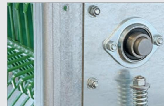
Palier applique avec flasque en tôle d'acier dans un élévateur d'œufs
