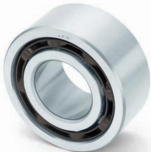
Les roulements à billes à contact oblique, montés sur les disques des déchaumeurs compacts AMAZONE qui traitent le sol, sont protégés par leur fabricant, BBG Leipzig, par des boîtiers étanchéifiés. Chacun des roulements à deux rangées de billes à contact oblique fonctionne dans son propre palier. Le disque lui-même sert aussi de couvercle au boîtier.
