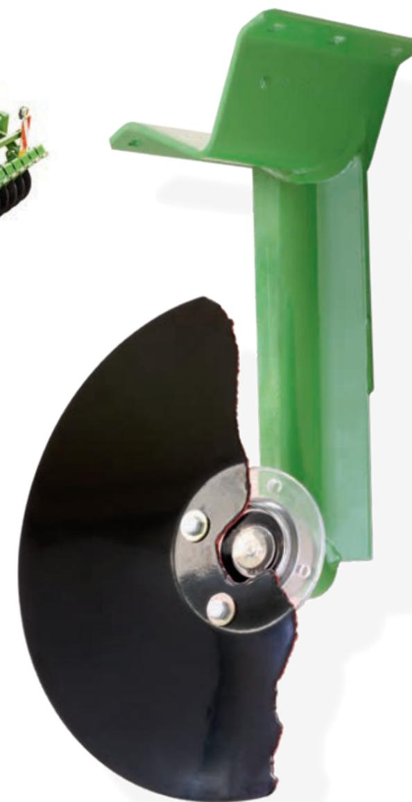
Le travail des champs peut ainsi se dérouler de manière parfaitement fiable. Les disques concaves sont disposés en deux rangées, l'une derrière l'autre. L'angle de coupe est prédéterminé de façon fixe, tandis que le décalage des rangées de disques est réglable. Grâce aux roulements LFD, les disques concaves à suspension en caoutchouc élastique, comme le rouleau rayonneur arrière, fonctionnent sans maintenance.
